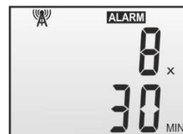
**8x** - zobrazuje údaj, kolikrát bude ještě odeslána pravidelná zpráva, než dojde k novému nastavení snímače (je-li tento požadavek v cloudu aktuálně nastaven). Údaj se s každou odeslanou pravidelnou zprávou snižuje. Čtení nového nastavení z cloudu nastává v okamžiku, kdy displej ukazuje „1x 0 min“. Je-li vzdálené nastavení ve snímači zakázáno, tento řádek se nezobrazuje.
